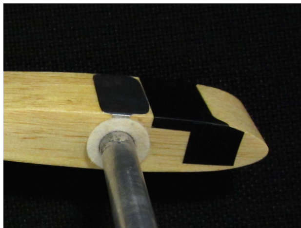
Figura 4.11: Particolare posteriore del profilo. Il catodo è collegato al tubo che fa da terra .
