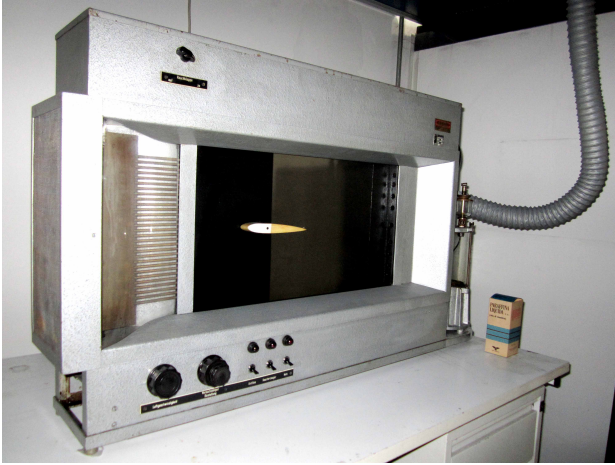
Figura 3.1: Galleria del vento.
