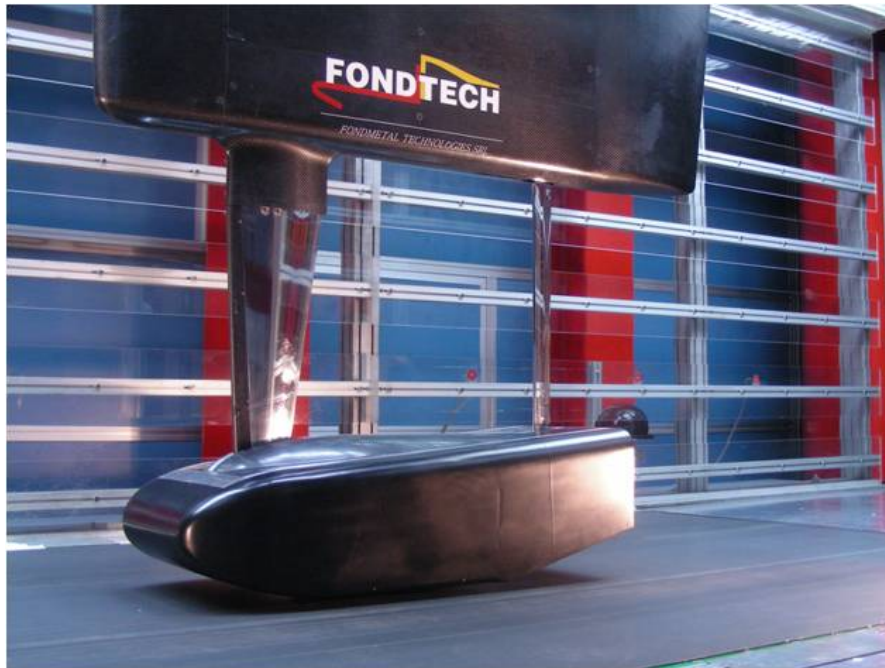
Figura 6.1: Modello Odoacre in galleria del vento.
