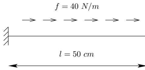
Figura 1: Asta soggetta a carico di trazione distribuito.
