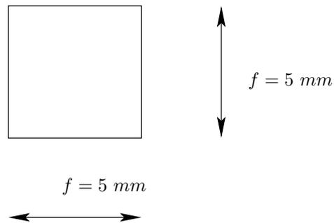
Figura 2: Sezione dell'asta.
